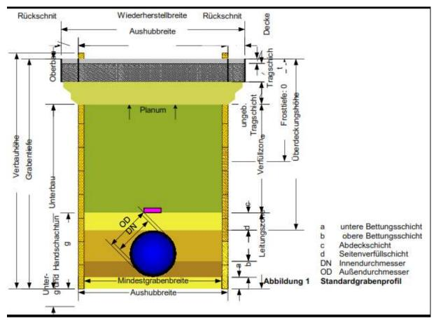
Bei Tiefbauleistungen werden grundsätzlich standardisierte Grabenprofile und entsprechende Begriffe verwendet (s. Abbildung 1). Grabenbreite und Grabentiefe sind abhängig vom Außendurchmesser des zu verlegenden Mediums und werden im Kapitel 4 in ihren Dimensionen angegeben. Werden größere Breiten oder Tiefen für die Ausführung benötigt, können diese nur nach vorheriger Abstimmung mit dem Auftraggeber vergütet werden.
