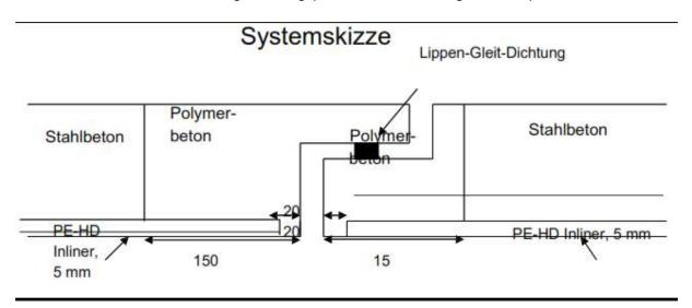
Der Inliner ist mit einer lückenlosen durchgängigen radialen Verankerung an den beiden Rohr- enden zu versehen. Eine zeichnerische Darstellung ist mit dem Angebot einzureichen.
