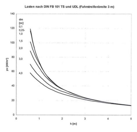
Diagramm DO-1 Bodenspannung pv infolge Tandemsystem (Doppelachse) LM1 für Überdeckungen über Rohrscheitel h = 0.6 m bis 5 m, mittlerer Rohrdurchmesser: dm=0.5\*(da+di)
